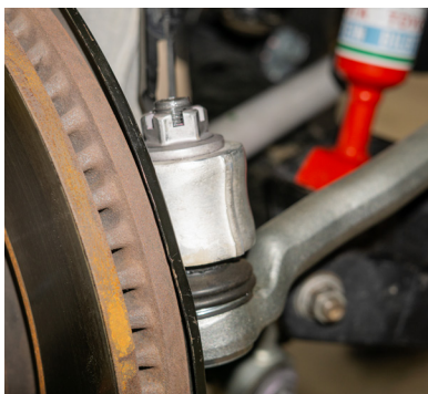
Fig. 1: Tie rod end link.
