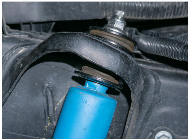
Fig. 16: Remove stem top nut.
